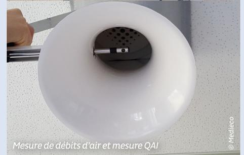
Mesure de débits d'air et mesure QAI
