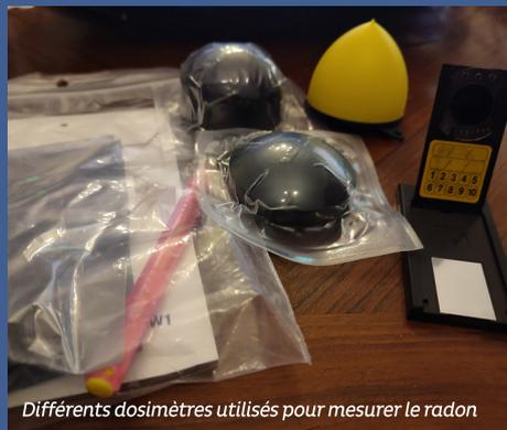
Différents dosimètres utilisés pour mesurer le radon
