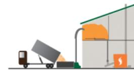
Silo en hauteur accessible par souffleur ou convoyeur ascensionnel HEIZOTRANS et alimentation de la chaudière au niveau inférieur par tube de chute.
